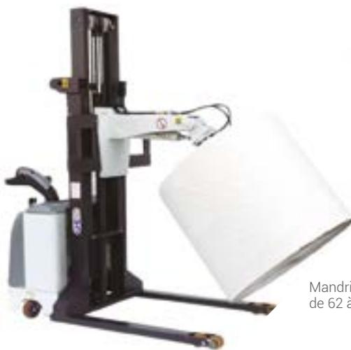
Rotation de la bobine par mandrin hydraulique
