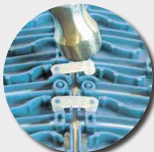
Montage des clips avec un marteau pour joindre un rouleau à un autre
