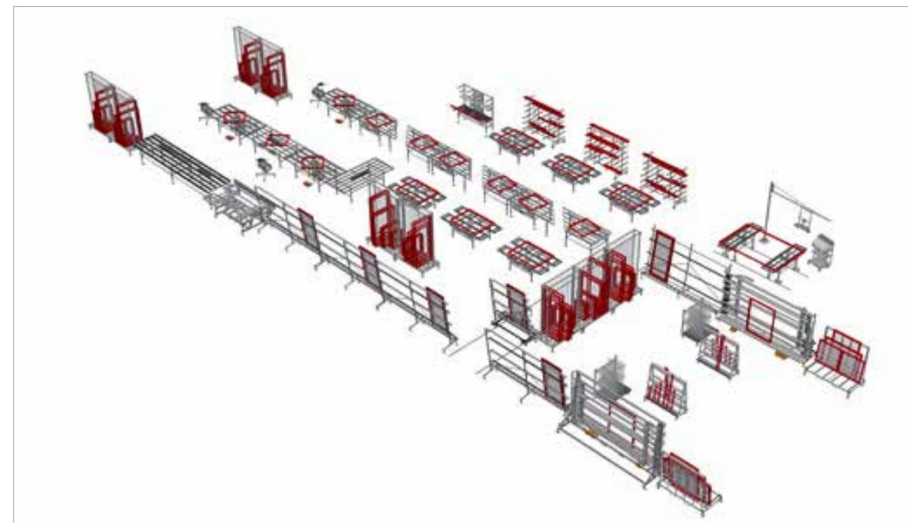
Exemple de ligne de montage pour la fabrication de fenêtres et de portes en aluminium
