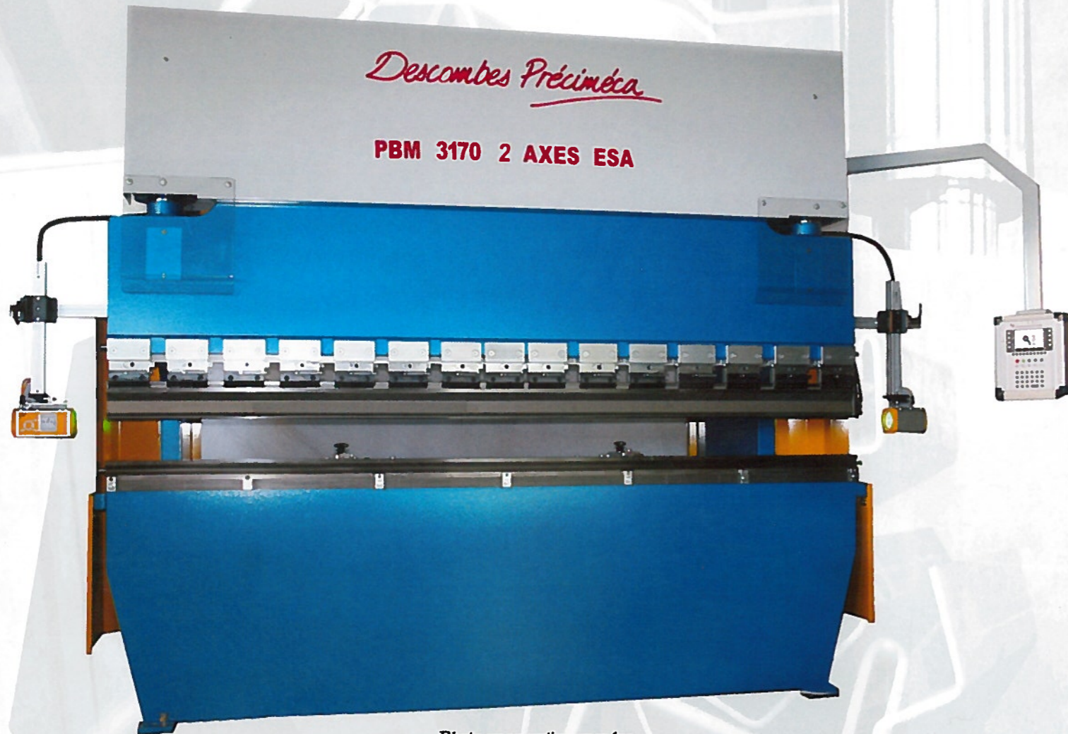
Photo avec option caméra et poste de commande à droite
