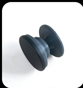
Impression bi-matériaux Matières TPC et PLA Impression en 1 heure 7 minutes
