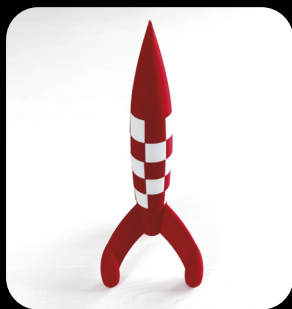
Impression bi-couleur Matière PLA Impression en 3 heures 38 minutes
