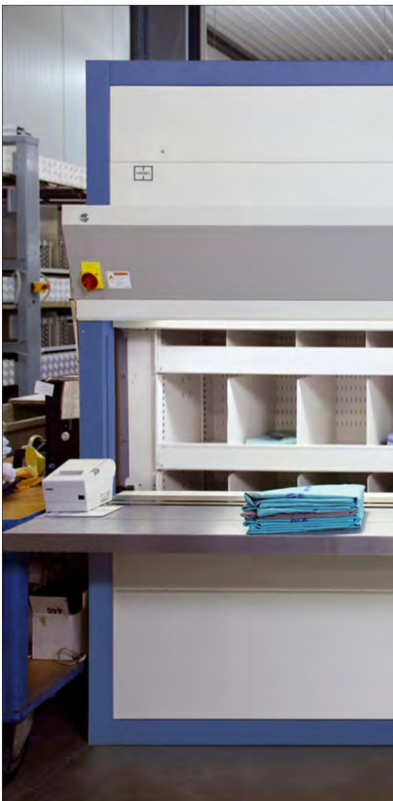
**Deux barrages lumineux permettent de préparer les commandes en toute sécurité dans toute la zone de prélèvement**
