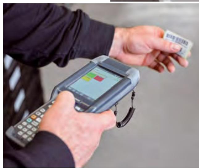
L'opérateur peut demander les articles en tapant un numéro sur la commande ou à l'aide d'un lecteur de codes-barres
