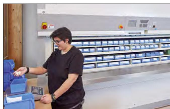
Le produit en vrac est compté à l'aide d'une balance compteuse juste à côté du stockeur, puis mis à la disposition de l'assemblage
