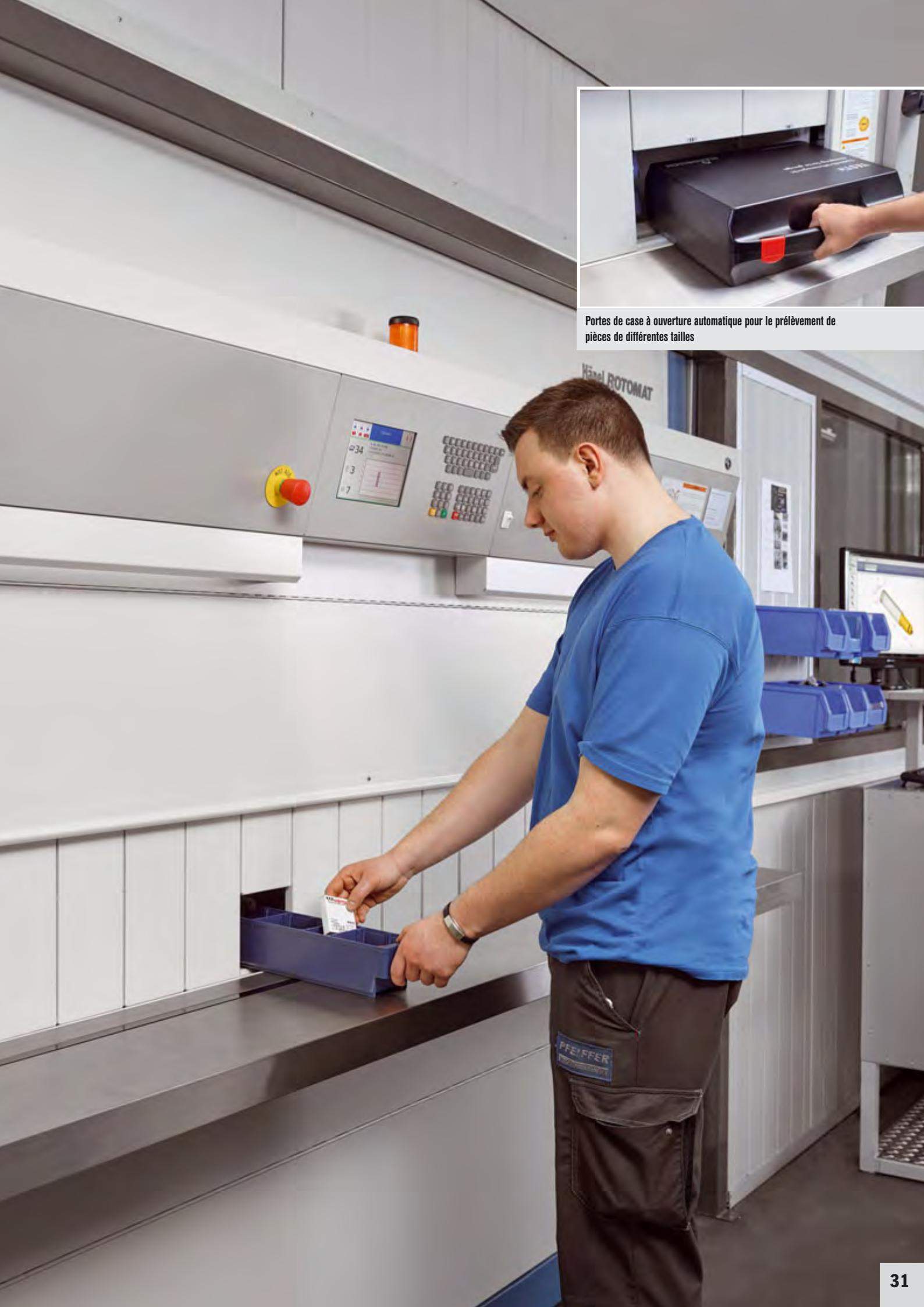
Portes de case à ouverture automatique pour le prélèvement de pièces de différentes tailles
