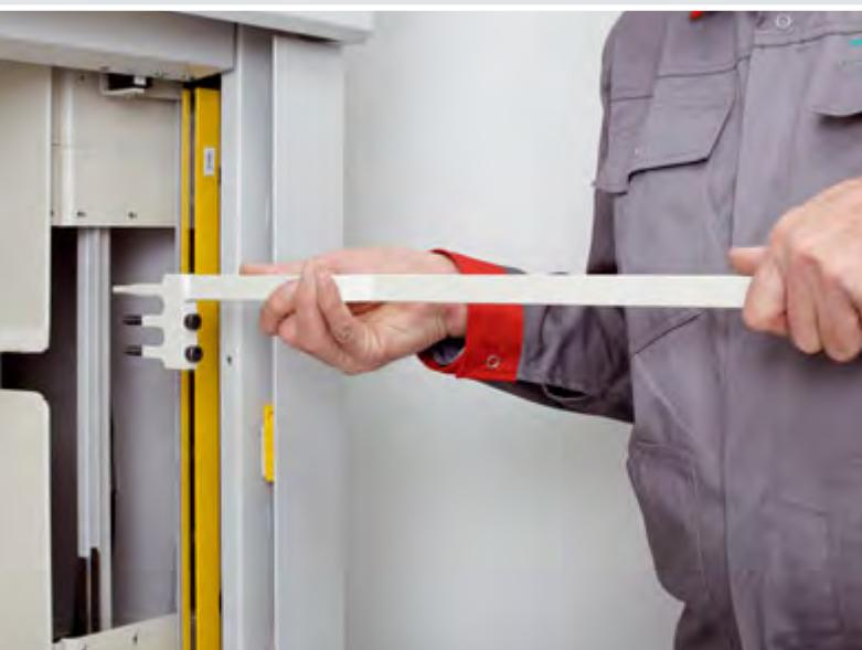
Le dispositif de blocage Hänel sécurise la maintenance du stockeur Hänel Rotomat®
