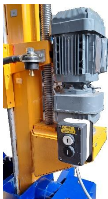
Serrage contre galet électrique (U600-E)
