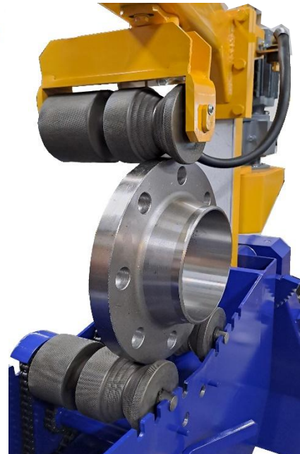
Galets en 'V' pour serrage bride
