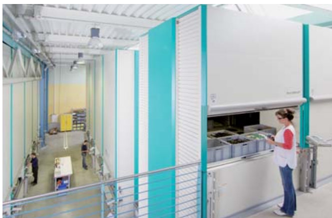
En fonction de leur hauteur, les Hänel Lean-Lift® peuvent être équipés de points de prélèvement disposés à des étages différents. Plusieurs personnes peuvent utiliser un Hänel Lean-Lift® en même temps à différents postes et à différents niveaux
