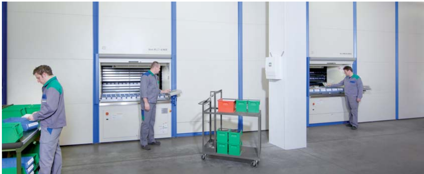
Deux Multi-Space® Hänel d'une largeur de 9,57 m chacun servent de magasin central pour la production
