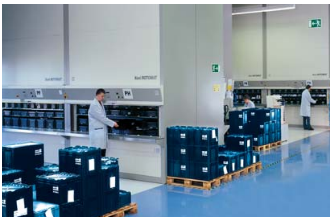
Stockage antistatique dans un stockeur Hänel Rotomat® placé dans l'atelier de production
