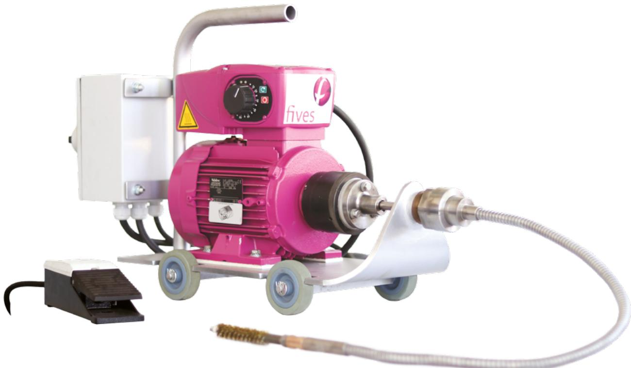
L'appareil TUBENET est dédié au nettoyage interne des tubes. Il permet d'augmenter le rendement de votre installation et de réduire votre consommation d'énergie tout en gagnant du temps. L'appareil fonctionne avec un moteur électrique asynchrone de 3000 trs/min avec variateur.
