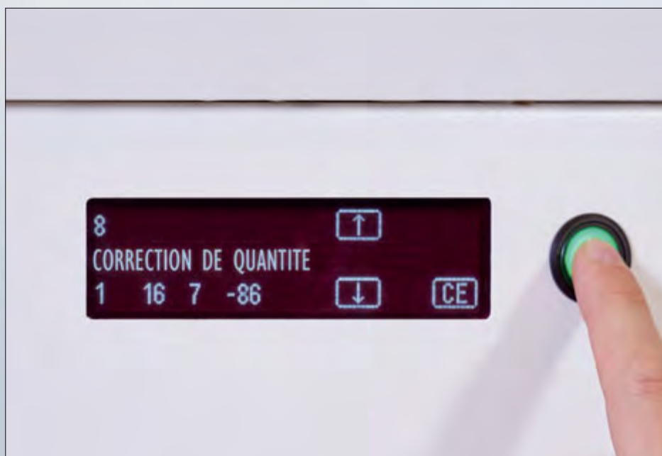
L'afficheur numérique de préparation Hänel n'indique pas seulement où se trouve l'article demandé ; il fournit aussi des informations supplémentaires sur l'article et l'emplacement
