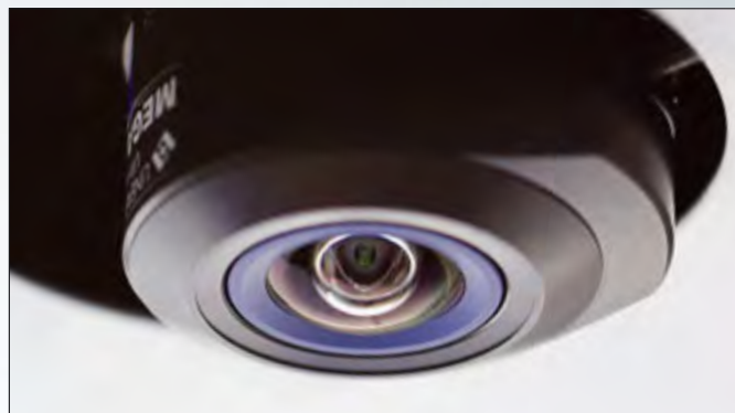
Lors de chaque mouvement de stock, un appareil photo intégré au stockeur prend une image du conteneur situé dans le point de prélèvement
