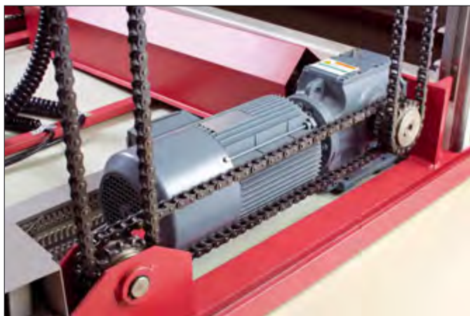
Grâce à des moteurs efficaces et puissants, la vitesse de déplacement de l'extracteur atteint jusqu'à 2,30 m/s
