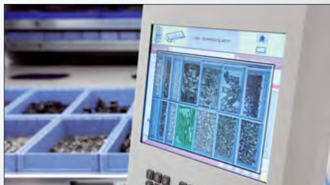
On peut regarder les photos des plateaux directement sur la commande. En outre, l'emplacement de l'article demandé s'affiche sur la photo du conteneur
