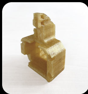
Matière ULTEM™ PEI 1010 Impression en 1 heure 29 minutes
